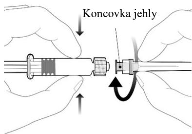
Připevněte jehlu k injekční stříkačce jemným připojením koncovky jehly k adaptéru Luer Lock a pooteče o čtvrt otáčky ve směru hodinových ručiček, dokud nepocítíte, že zapadla.
